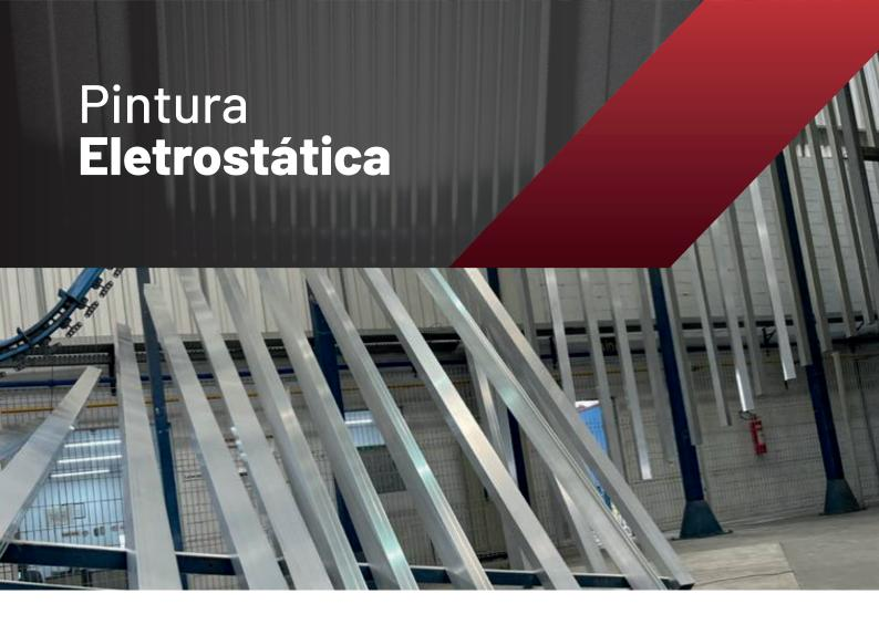
As fábricas do Grupo CDA Metais estão equipadas com linhas de pintura vertical e horizontal, às quais possuem tecnologia de pintura por pistolas eletrostáticas convencionais e disco, garantindo assim uma camada uniforme do polyester ao longo do perfil e maior reaproveitamento dos resíduos do pó.
