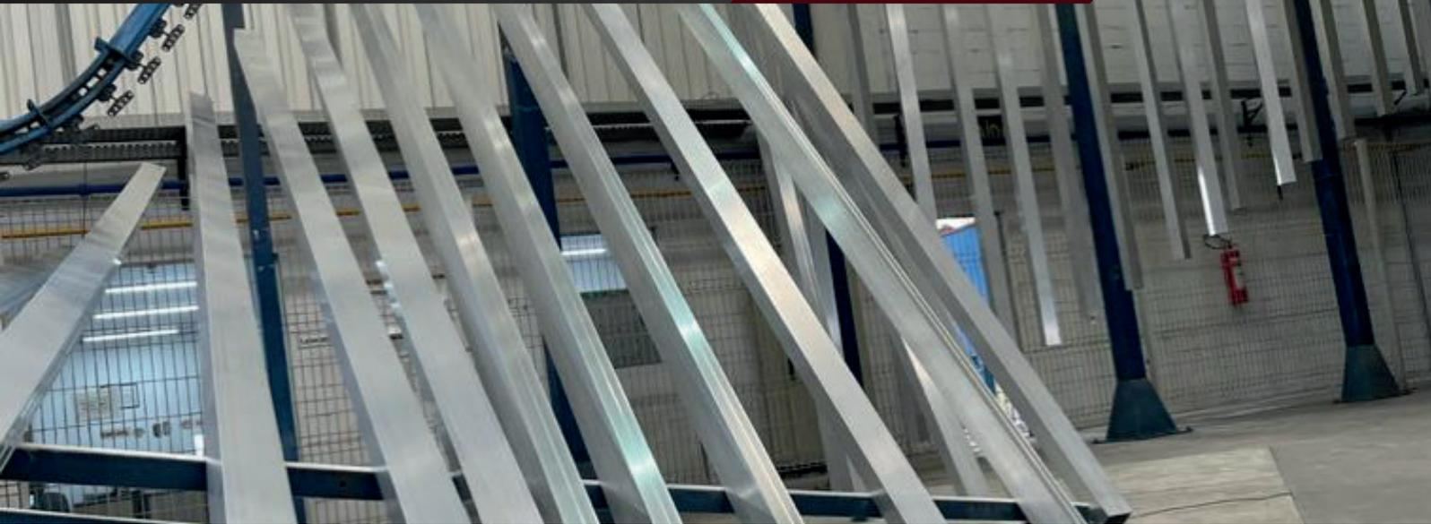
As fábricas do Grupo CDA Metais estão equipadas com linhas de pintura vertical e horizontal, às quais possuem tecnologia de pintura por pistolas eletrostáticas convencionais e disco, garantindo assim uma camada uniforme do polyester ao longo do perfil e maior reaproveitamento dos resíduos do pó.
