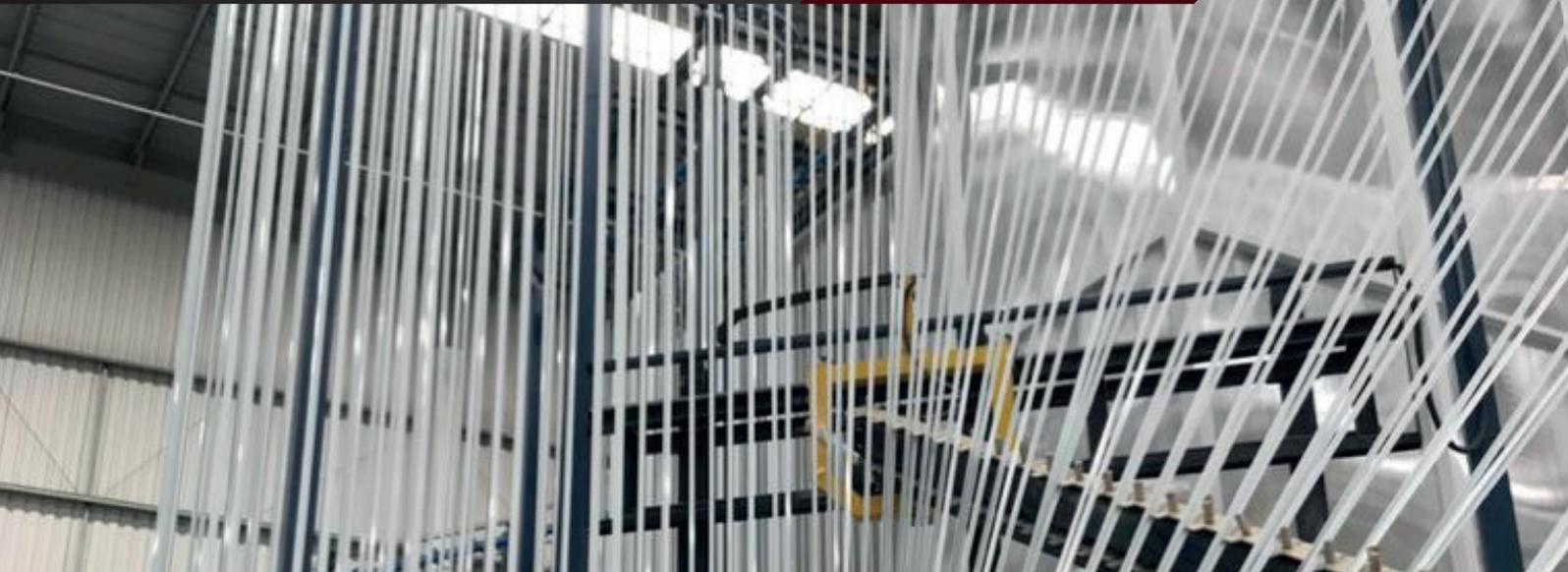
Nossas linhas de pintura realizam a decapagem e desengraxe dos perfis em apenas um estágio, o qual resulta em uma redução no consumo de água de 5.000 litros por hora para os atuais 600 litros por hora. Os efluentes são devidamente tratados nas modernas estações de tratamento de efluentes, onde a água é filtrada e reutilizada nas próprias instalações industriais, buscando sempre minimizar os impactos ambientais.
